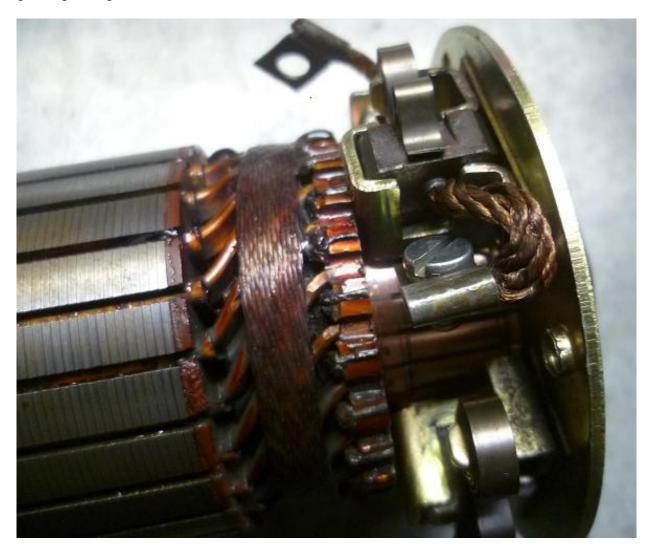
Die Kohle-Bürsten sind mit einem Querschnitt von 7 x 14 mm identisch mit denen an meinem Marelli-Anlasser an meiner V7-Guzzi, die Länge lässt sich zurechtschleifen. Der Anlasser-Motor läuft jetzt wieder mit Kraft und Höchstdrehzahl.
