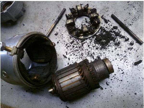
Zuerst wird der Motor langsamer, hat nicht mehr die Kraft, die Fliehkraftkupplung kraftschlüssig einzuklinken und erleidet dann den endgültigen Tod infolge so eines Kollektors (wie oben).
