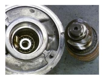
Sogar das größere Lager des Schneckenrads war trotz zweier Gummi-Dichtscheiben mit Messing-Abrieb durchdrungen. Nachdem das Öl verschwunden ist, bleibt eine Paste aus Goldstaub und Restöl übrig, die alle Lager sehr schwergängig macht:
