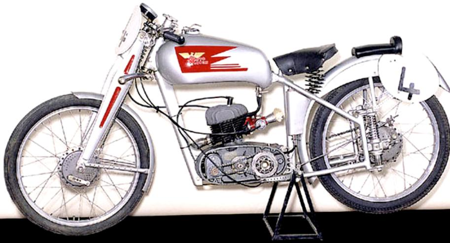
**1949** Der erste WM-Lauf wird durchgeführt. Moto Morini entwickelt seinen ersten 125cc Viertakt-Rennmotor welcher in der Moto Morini 125 GP Monoalbero zum Einsatz kommt. Am Zenit seiner Entwicklung leistet diese Antriebseinheit stolze 16 PS bei 10.000 U/min und erreicht eine Topspeed von 160 km/h. Beim Grand Prix in Monza im Jahre 1953 fährt Mendogni die Rekordrunde mit 143,2 km/h Durchschnitt.
