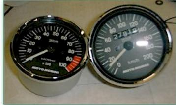
...und die hervorragend von Maximilian Mahlmeister restaurierten Instrumente. Die Einfassungsgummis sind noch in einem guten Zustand und werden nur mit Hirschtalgfett behandelt. Die Anzeigelämpchen werden auf LED umgerüstet, davon mehr auf der nächsten Seite.
