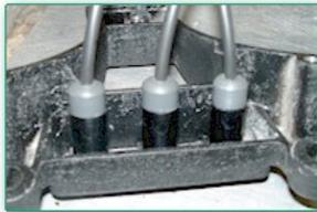
Das Innenleben der Anzeigelämpchen wird durch ultrahelle LEDs ersetzt.
