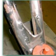
Der Riss am Rahmen wird nur kehlförmig erweitert und wieder zugeschweisst.
