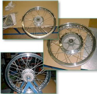
Tja, und irgendwo müssen die Räder jetzt auch rein, d.h. Schwinge und Gabel sind nun dran. Die Schwingenlager zeigten sich bei der Demontage schon von ihrer besten Seite: in Ermangelung jeglichen Schmierstoffs waren Achse und Lagerbuchsen eine reibende Verbindung eingegangen. Die Lagerbuchsen kann man mit viel Glück und reichlich Wärme in einem Schraubstock herauspressen. Klappt das nicht, muss man einen Betrieb aufsuchen, der eine Hydraulikpresse sein eigen nennt.
