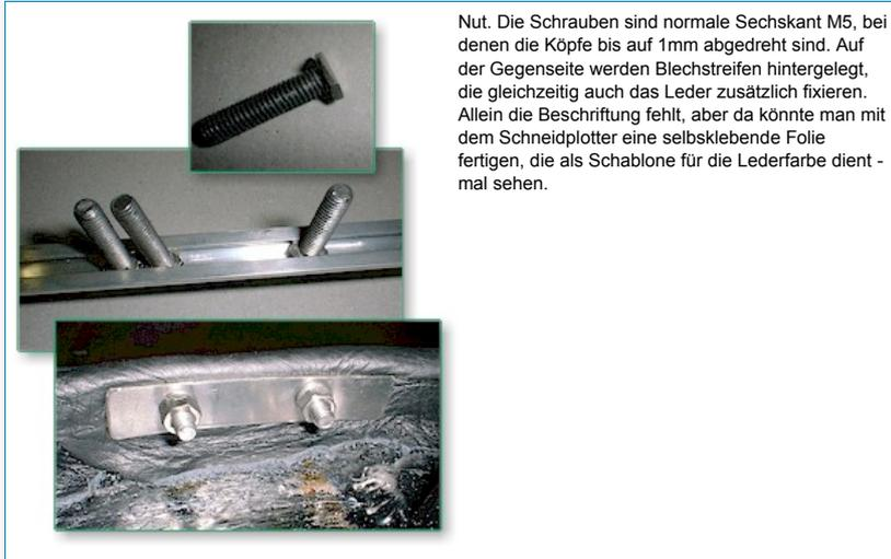
Nut. Die Schrauben sind normale Sechskant M5, bei denen die Köpfe bis auf 1mm abgedreht sind. Auf der Gegenseite werden Blechstreifen hintergelegt, die gleichzeitig auch das Leder zusätzlich fixieren. Allein die Beschriftung fehlt, aber da könnte man mit dem Schneidplotter eine selbstklebende Folie fertigen, die als Schablone für die Lederfarbe dient - mal sehen.
