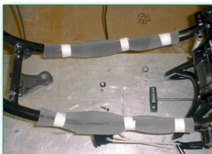
Wenn man den Motor allein einsetzt, sollte man ein paar Maßnahmen zum Schutze des Rahmens unternehmen, hier in Form von Gummimattenstreifen um die Rahmenrohre, damit man bei Einbau nicht gleich dieselbigen verkratzt.
