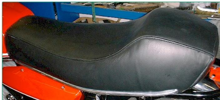
Auf dem Bild sind schon die Zierleisten zu sehen, die ich als Stangenware auf einem Oldtimermarkt erstanden habe. Die Enden werden plattgeklopft, zurecht gefeilt und poliert. Zuvor müssen aber die Schiebescrauben in die
