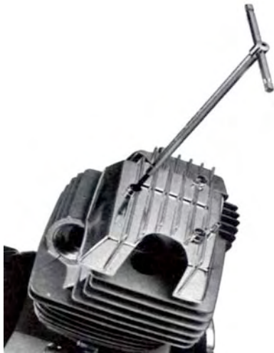
Abb. 34 Entfernung der Schrauben des Zylinderkopfdeckels
