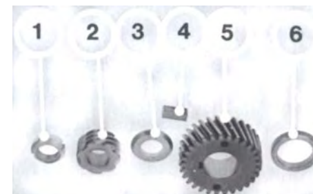
Abb. 86 1) Nutmutter 2) Schneckenrad zur Steuerung der Ölpumpe 3) Distanzring 4) Keil 5) Zahnrad des Primärtriebs 6) Distanzring 7)
