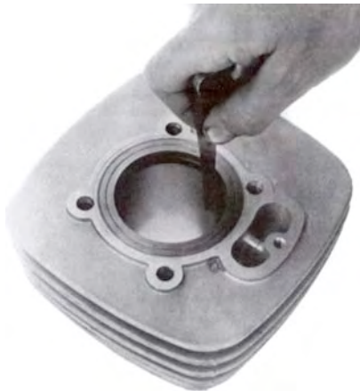
Abb. 62 Kontrolle des Abstands der Kolbenringenden
