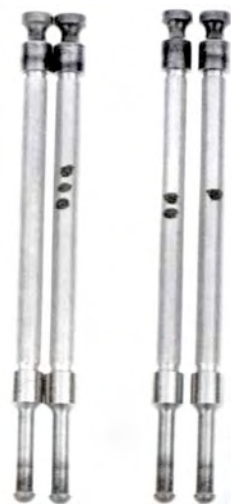
Abb. 38 Anbringung der Bezugszeichen an den Stößelstange
