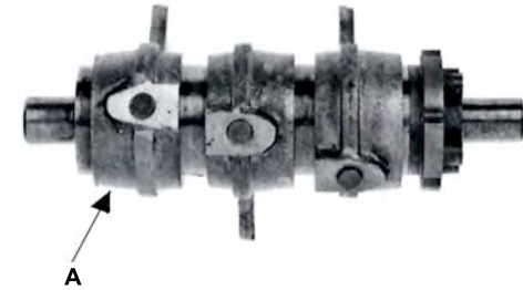
Abb. 152 Den mit dem Pfeil (A) gekennzeichneten Bereich leicht glätten
