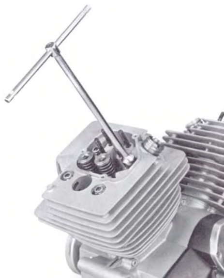
Abb. 37 Entfernung der Stößelstangen
