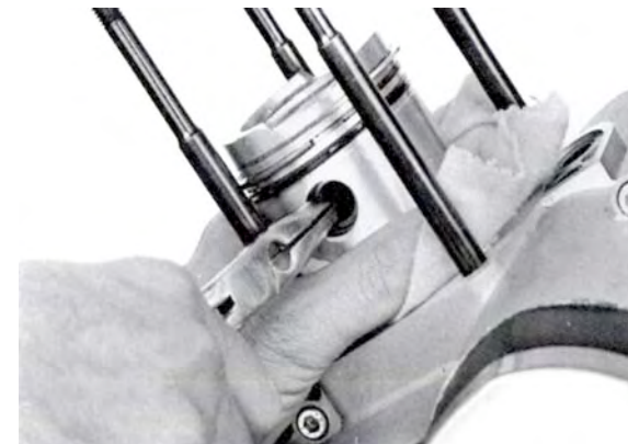
Abb. 46 Entfernung eines Drahtsprengring
