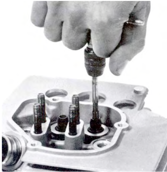
Abb. 53 Aus reiben der Ventileführungen
