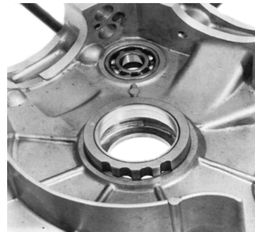
Abb. 146 Einsetzen der Buchse in ihren Sitz
