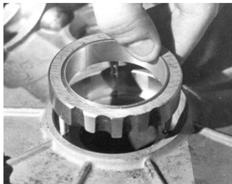
Abb. 145 Die Buchse richtig einsetzen
