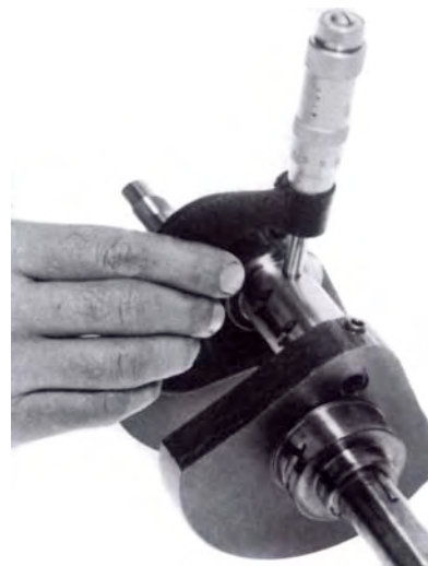
Abb. 132 Messung des Durchmessers des Kurbelzapfens
