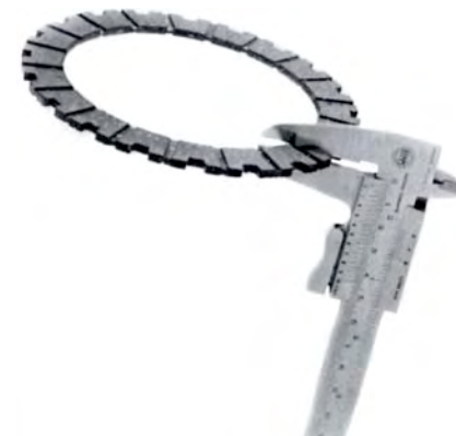
Abb. 88 Kontrolle der Stärke der Kupplungsscheiben
