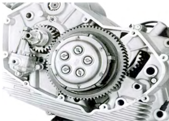
Abb. 83 Kupplungsgruppe im Ölbad – Primär Antrieb (Modelle 125-250 ccm)
