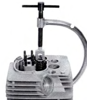
Abb. 42 1) Werkzeug zum Zusammendrücken der Ventildfedern
