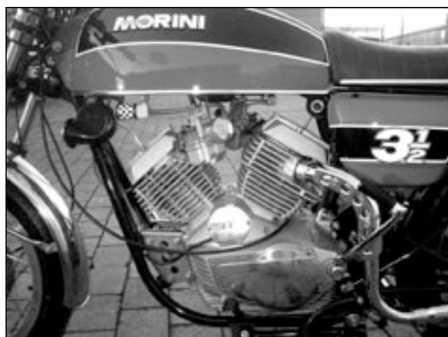
Alle Aluminiumteile des Motors ( Gehäuse, Zylinder, Zylinderkopf, Vergasergehäuse und Motordeckel) habe ich glasperlgestrahlt. Die Seitenflächen der Deckel und der Deckel vom Pick-Up habe ich neu poliert. Ach ja, ein nagelneuer Pick-Up sowie eine komplett neue Auspuffanlage nebst Krümmer war schon dabei, Freude!
